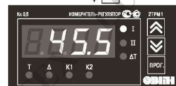
Рисунок 22. Изменение уставок малого и большого горения котла
